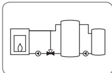
Système 4: Chaudière à combustible solide avec échange de chaleur
