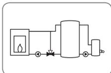
Système 3: Chaudière à combustible solide avec chauffage d'appoint
