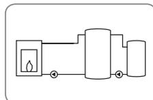
Système 8: Chaudière à combustible solide avec échange de chaleur
