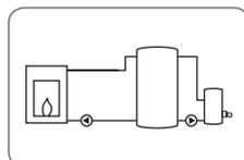
Système 7: Chaudière à combustible solide avec chauffage d'appoint
