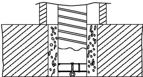
Verguß Normalmauermörtel der Mörtelklassen M2,5; M5 oder M10 nach DIN EN 998-2, oder Beton
