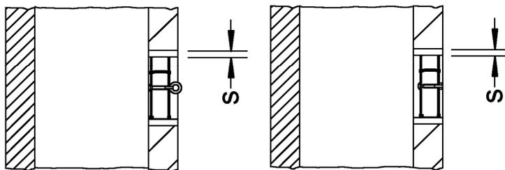
Schachtwanddicke ohne innenliegende Stahlblechleitung **mind. 60 mm**
