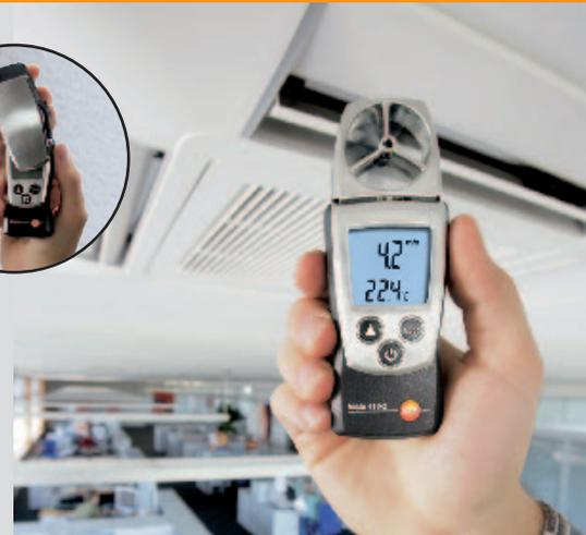
Strömungsmessung am Kanalauslass mit 40 mm-Flügelrad
