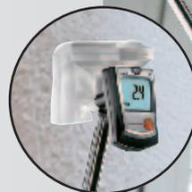
Einfaches Ablesen der Messwerte durch flexibles Gelenk
