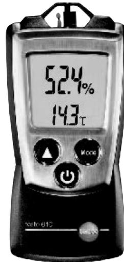
testo 610; Feuchte- und Temperatur-Messgerät inkl. Schutzkappe, Batterien und Kalibrier-Protokoll
