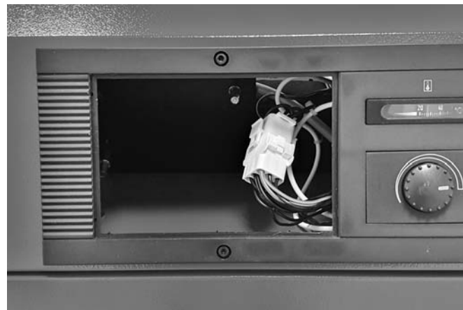
Abb. 29: Offener Reglerschacht mit Steckverbindung für den Regler-Kabelbaum.
