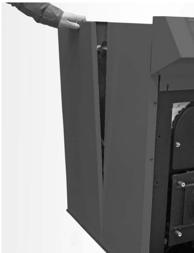
Abb. 5: Demontage der seitlichen Verkleidung
