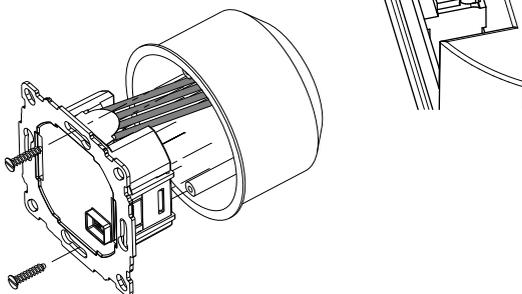
Die Drähte müssen so montiert werden, daß der Plastikstreifen als Isolation zur Befestigungsschraube wirkt.
