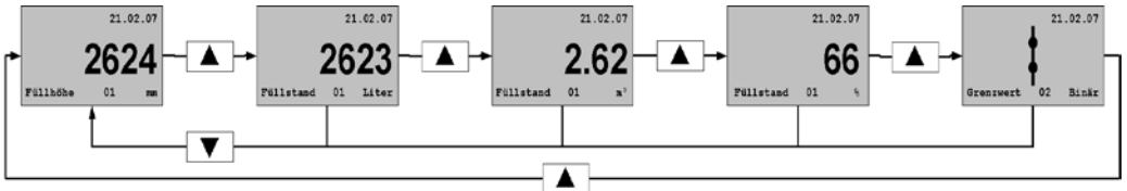
Fig. 19 : Afficher le niveau dans les unités disponibles et le seuil (avec sonde à flotteur)
