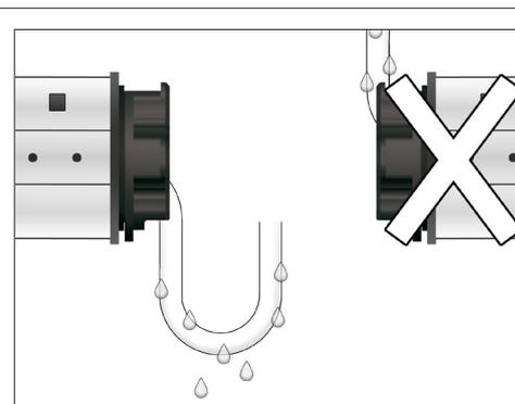
Abb.3: Verlegung des Anschlusskabels
