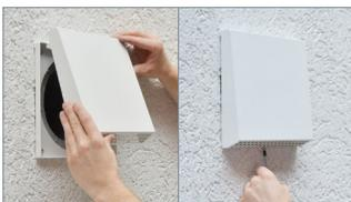
Nach Abschluss der Dämm- / Putzarbeiten entfernen Sie die Putzdeckel auf der Innen- und Außenseite. Passen Sie die Wanddurchführung dem Maß der Fertigwand an, indem Sie die Wanddurchführung mit einem Teppichmesser oder einem Heißdraht **raum- und fassadenseitig wandbündig** kürzen.
