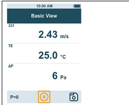
Je nach angeschlossenem Fühler können Parameter für die Messung eingestellt werden, wie beispielsweise die Sichtbarkeit einzelner Werte oder die Einheiten.
