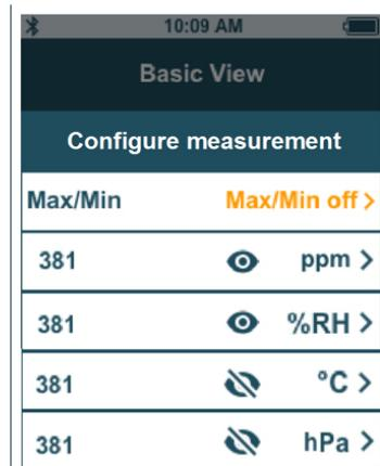
Werden einzelne Werte ausgeblendet, hat dies keinen Einfluss auf die Anwendung, nur auf die Standardansicht und die Langzeitmessung. Die eingestellten Einheiten werden hingegen auch in die Anwendungs-Menüs übernommen.
