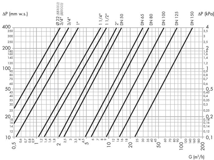
Die maximal empfohlene Fließgeschwindigkeit an den Anschlüssen beträgt ~ 1,2 m/s. Die folgende zeigt die maximalen Durchflussmengen, die diese Bedingungen erfüllen.
