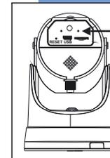
Si la LED de connexion clignote constamment, la connexion entre caméra et routeur est établie
