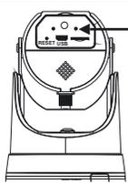
Alimenter la caméra en courant (5 V DC) via un câble de connexion microUSB près d'un routeur. Une LED de connexion bleue clignote 3x régulièrement. Si la LED ne clignote pas, réinitialiser (maintenez la touche Reset enfoncée pendant 1 min).
