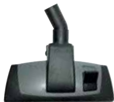
Bodendüse Premium • Breite: 280 mm • Anschluss-innen ø: 32 mm • Umschaltbar Teppich/Hartboden • Rundbürstenleiste
