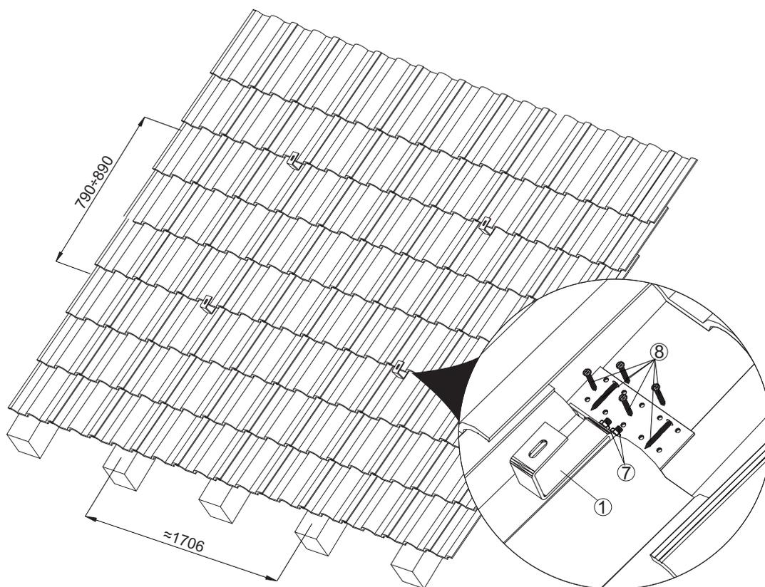
Installer les crochets et remettre les tuiles.
