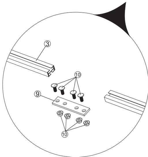
Mettre deux vis ⑩ dans la partie inférieure du profilé en aluminium ③ d'un des kits de montage et deux vis dans la partie inférieure du profilé en aluminium de l'autre kit de montage. Rapprocher les deux profilés en aluminium et ensuite, installer le raccord de la poutre ⑨ et vis avec force.
