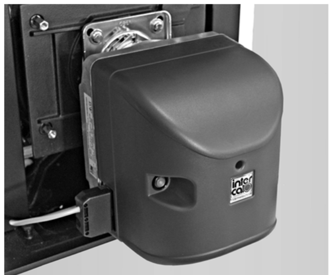
Abb. 4: Am Kesselflansch mit 2° Neigung montierter Brenner
