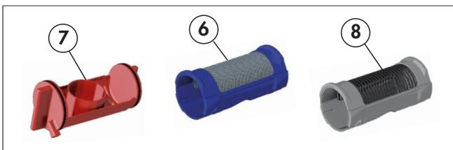
Le filtre fourni (bleu) est formé de mailles métalliques avec une capacité de filtrage des particules ayant un diamètre supérieur à 0,3 mm. Cette maille filtrante spécifique permet de bloquer toutes les particules qui restent en circulation, en exécutant au mieux l'opération de première filtration des tuyauteries. Une fois que le DIRTMAGPLUS® a été isolé et vidé, le filtre (6) peut être inspecté facilement pour exécuter les opérations suivantes :
