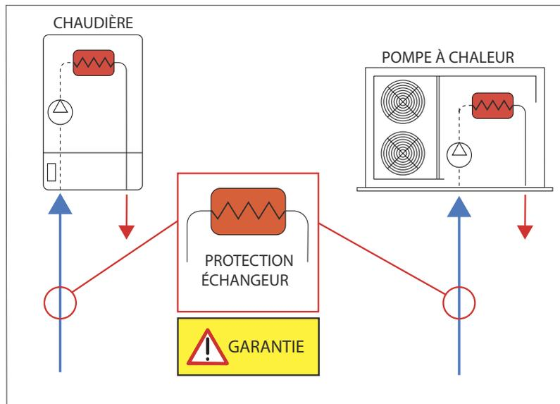
protégé de manière adéquate par un filtre, dès l'instant de sa mise en service. Actuellement, les pots de décantation et les filtres présents sur le marché ne sont pas en mesure d'assurer la protection des composants au cours de chaque phase de service.
