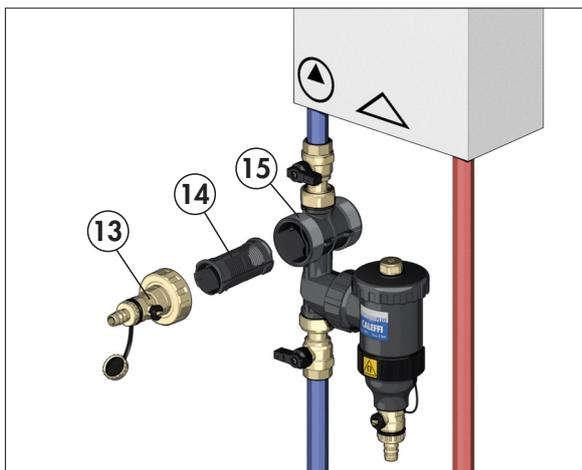
Le kit accessoires pour le remplissage et le rinçage du circuit (code F49476) est formé d'un bouchon/robinet de vidange (13), d'un élément de couleur noir (14) à monter sur le boîtier du filtre (15).
