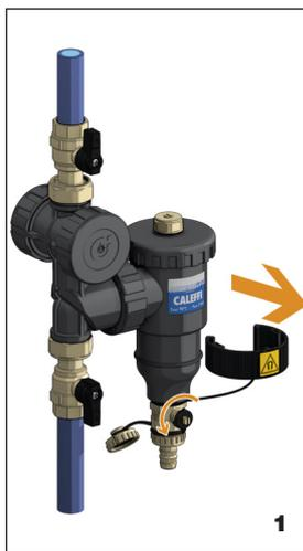
Enlever la bague renfermant les aimants (fig. 1) et évacuer les impuretés en ouvrant le robinet de vidange à l'aide de la clé (fig. 2) faisant partie du kit. Cette opération peut avoir lieu même pendant le fonctionnement de l'installation.
