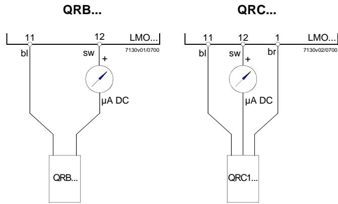
Alternativ kann zur Fühlerstrommessung auch das Interface OCI400 / mit PC-Software ACS400 / ACS410 verwendet werden. Hierzu entfällt der Anschluss des DC-Mikroampèremeters.
