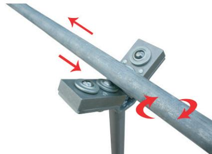
Tubi fino a 6" possono ruotare e traslare contemporaneamente senza attriti, grazie a robuste sfere d'acciaio con portata di 50 kg. ciascuna .
