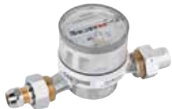
Eckventilzähler, Typ ETKD für Kaltwasser bis 30°C • Komplett mit Verschraubung für Eckventil und Quetschverschraubung für 10 mm Kupferrohr
