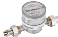
Eckventilzähler, Typ ETWD für Warmwasser bis 90°C • Komplett mit Verschraubung für Eckventil und Quetschverschraubung für 10 mm Kupferrohr
