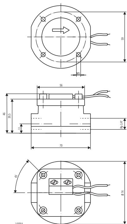
**Ferntotalisator zu VZO 4 OEM - RE 0.005 / Remote totalizer for VZO 4 OEM - RE 0.005 / Totalisateur à distance pour VZO 4 OEM - RE 0.005**
