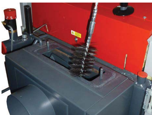
Vorführung der Reinigung des Rauchkanals mit Drahtbürste.
