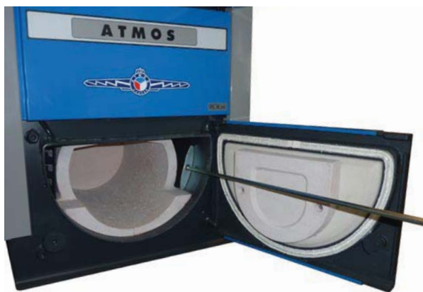
Offene untere Tür mit der Keramik-Kugelarum ausgestattet und seine Reimigung-Seitenwände der Verbrennungskammer durch den Putzkratzer
