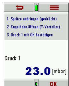
Bei großen Leitungsvolumen (>200 Liter) reicht ein Spritzeninhalt nicht aus, um eine genügend große Druckdifferenz zu erzeugen. Dies wird durch eine rote Farbe der Druckanzeige angezeigt.
