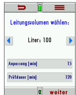
In diesem Fenster wird der zu prüfende Leitungsabschnitt mit dem Prüfdruck beaufschlagt.
