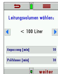
In diesem Fenster wird der zu prüfende Leitungsabschnitt mit dem Prüfdruck beaufschlagt.
