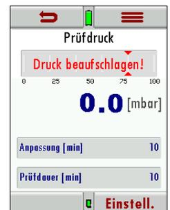
Mit dem Button „Anpassung [min]“ oder „Prüfdauer“ können die Zeiten geändert werden.
