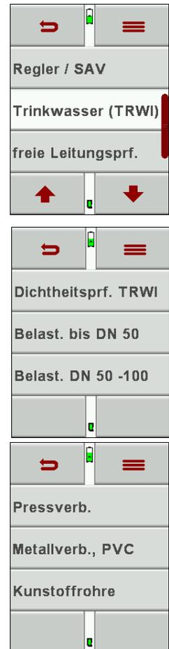
Diese Prüfung ist durchzuführen, wenn eine längere Stillstandzeit von der Dichtheitsprüfung bis zur Inbetriebnahme – insbesondere bei durchschnittlichen Umgebungstemperaturen  $>25^{\circ}\text{C}$  zu erwarten ist um mögliches Bakterienwachstum auszuschließen sowie bei Frostgefahr
