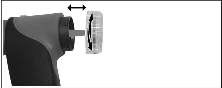
1. Filterkammer öffnen: Leichte Drehung gegen den Uhrzeigersinn.
