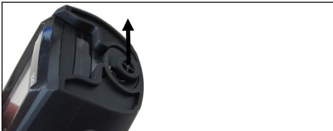
1. Kondensatauslass an der Kondensatfalle öffnen: Stopfen max. bis zum Anschlag herausziehen.
