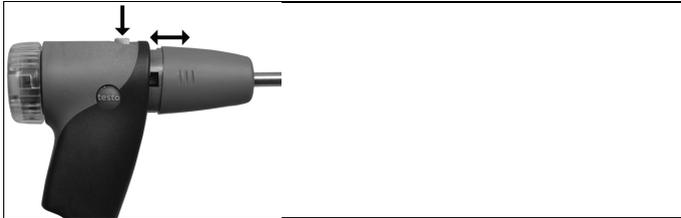
1. Sondenverriegelung durch Betätigen der Taste am Sondengriff lösen und Sondenmodul abnehmen.
