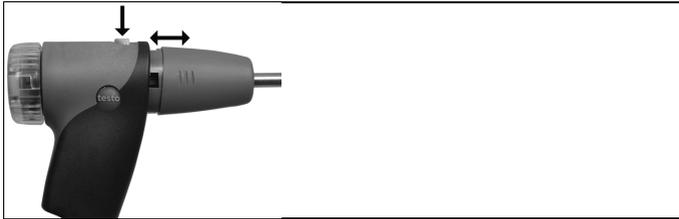
1. Taste an der Oberseite des Sondengriffs betätigen und Sondenmodul abnehmen.
