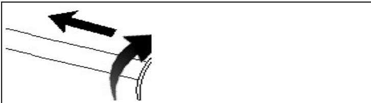
2. Verschlusskappe (2) im Uhrzeigersinn bis zum Anschlag drehen und Sondenrohr entfernen.
