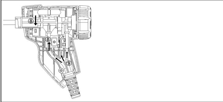
6. Adapter und Schlauch mit Thermoelement verbinden (8). Leitungen und Schläuche einpassen (9), Halbschaleneinsätze aufsetzen.
