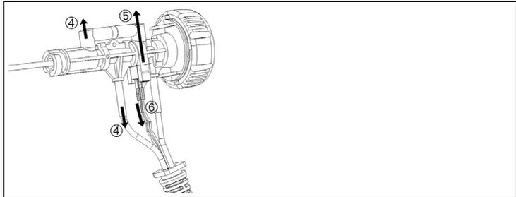
4. Adapter (4) und Schlauch (5) lösen, Thermoelement aus Halterung schieben und Kabel (6) vom Thermoelement entfernen.
