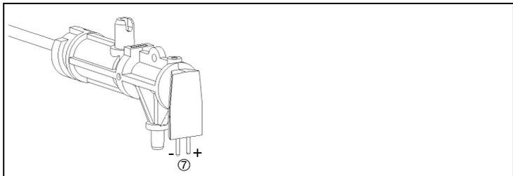
5. Leitungen an das neue Thermoelement anschließen (weiß -, grün +) (7) und Thermoelement wieder in die Halterung schieben.
