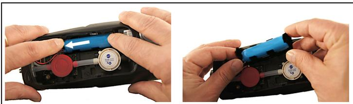
3. Halterung mit den Fingern leicht andrücken. Halteclip in Pfeilrichtung ziehen bis sich die Arretierung löst. Halterung entnehmen.
